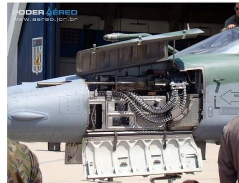
Canhão de 20 mm instalado no caça F5
